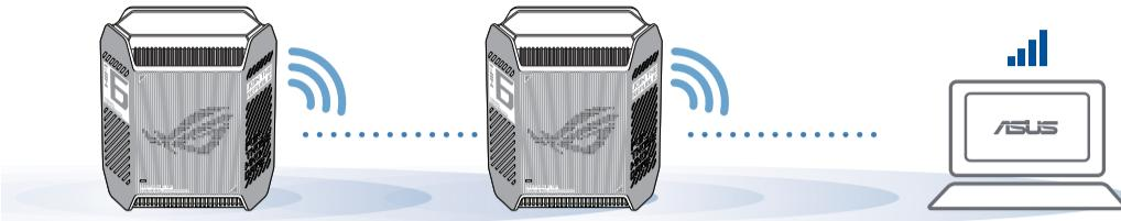
**NOTAS:** Para minimizar las interferencias, mantenga los routers alejados de dispositivos como teléfonos inalámbricos, dispositivos Bluetooth y hornos microondas.
