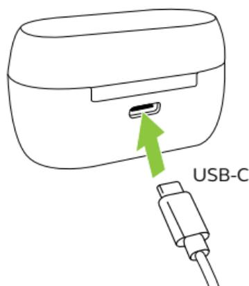
Se recomienda utilizar una fuente de alimentación con 5 V  $\pm$  0,25 V y una corriente de carga máxima menor de 2 A. No se recomienda cargar los auriculares o la carcasa de carga con una fuente de alimentación de mayor voltaje.
