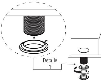
Asegúrese de colocar el empaque con la parte cónica hacia arriba como se muestra en el detalle 1.
