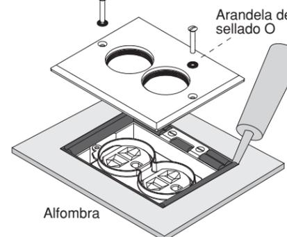
Apretar los tornillos de la placa de montaje a 9 pulg-lib.
