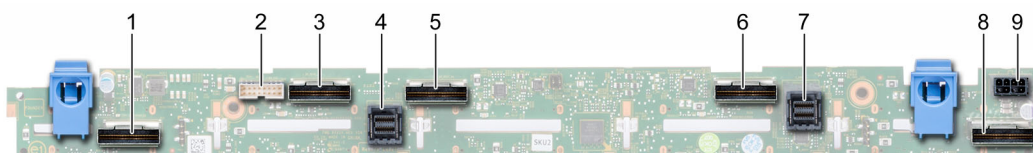
Ilustración 35. Backplane de unidad NVMe, SATA o SAS de 10 x 2,5 pulgadas
