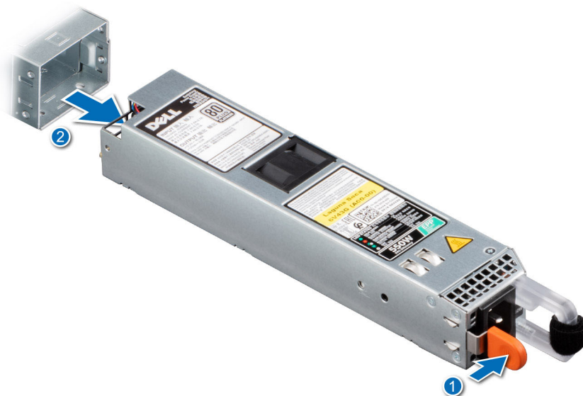
Ilustración 93. Extracción de una fuente de alimentación
