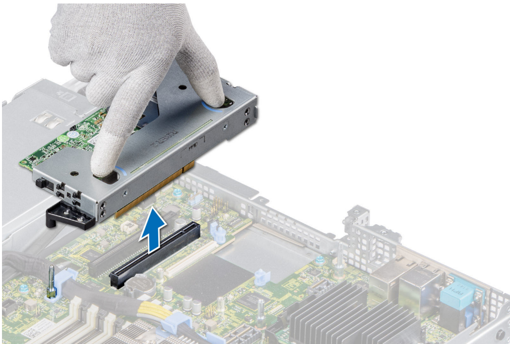
Ilustración 54. Extracción de la tarjeta vertical izquierda de perfil bajo
