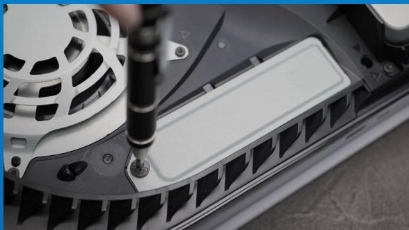
**REINSTALL THE EXPANSION SLOT COVER.**
