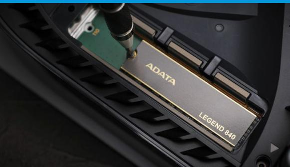
**FASTEN THE SSD WITH THE SCREW.**
