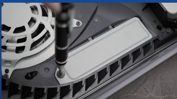
**LOOSEN THE SCREW TO REMOVE THE EXPANSION SLOT COVER.**
