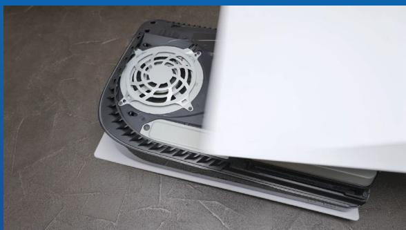
**REINSTALL THE BACKING PLATE BY SLIDING IT BACK AND PUSHING DOWNWARDS.**
