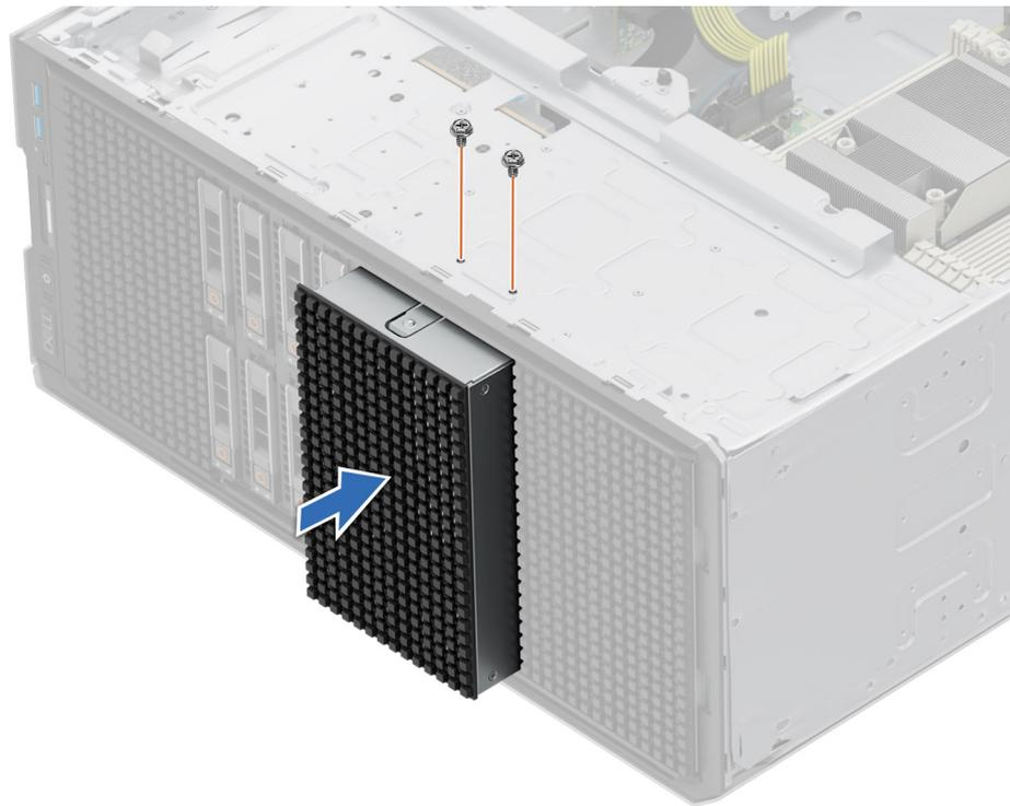
**Ilustración 116. Instalación del panel de relleno de la bahía de unidad**
