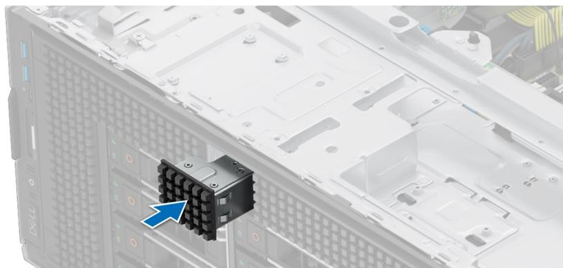
**Ilustración 139. Instalación del módulo de BOSS-N1 de relleno**
