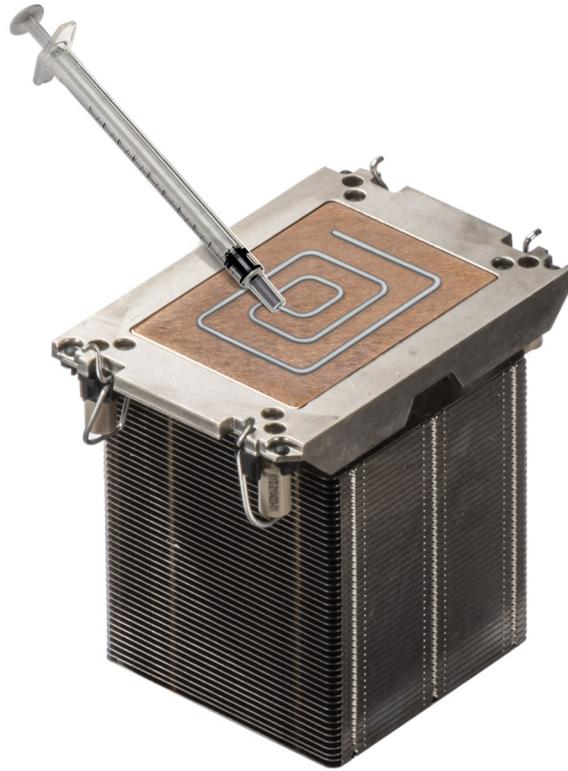
**Ilustración 167. Aplicación de la grasa térmica**
