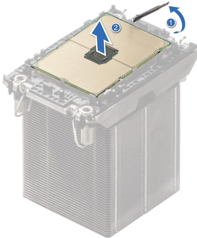
**Ilustración 163. Levante la palanca de liberación del TIM**
