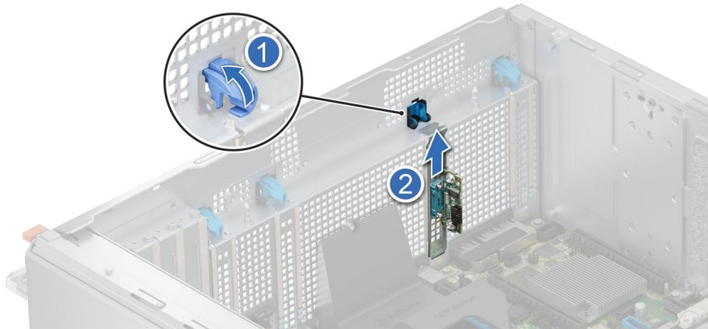
**Ilustración 178. Extracción del puerto serial de COM**
