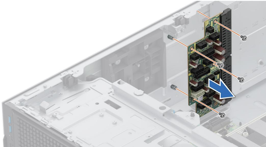
**Ilustración 193. Extracción de la tarjeta mediadora de alimentación**
