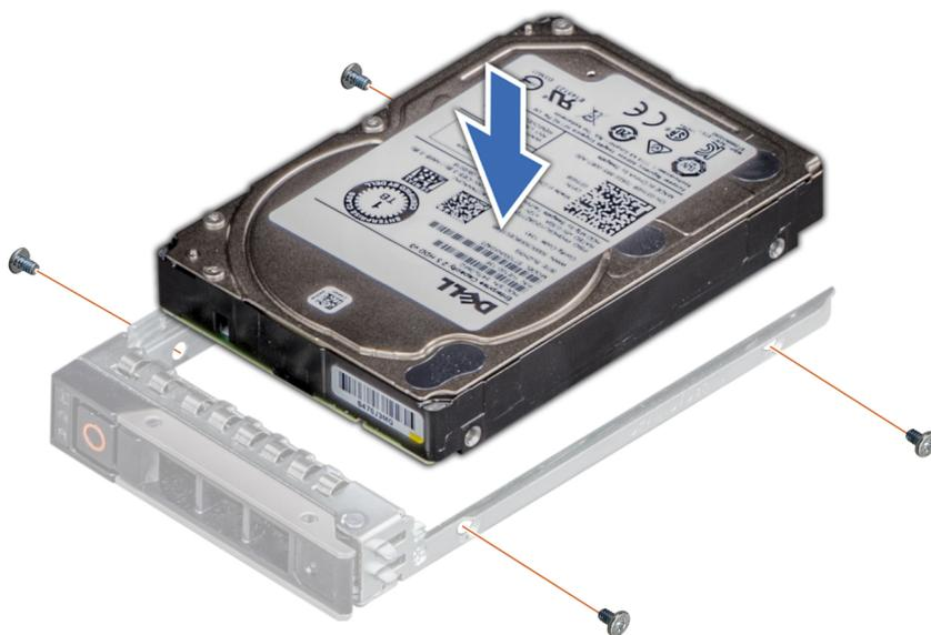
**Ilustración 104. Instalación de una unidad en el portaunidades**
