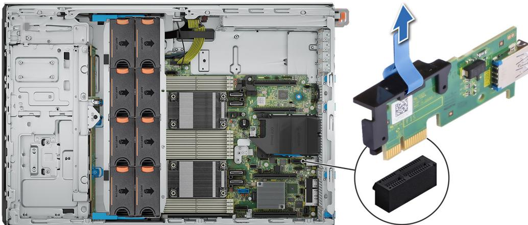
Ilustración 148. Extracción de la tarjeta USB interna
