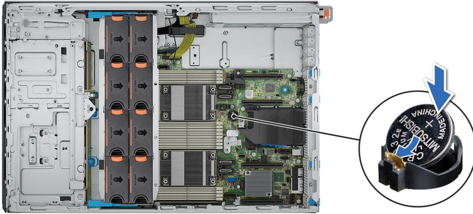
**Ilustración 181. Instalación de la batería del sistema**
