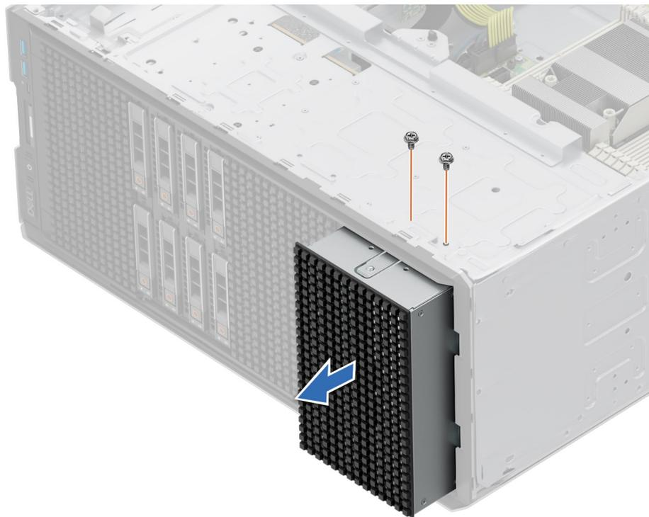
**Ilustración 114. Extracción del panel de relleno de la bahía de unidad**
