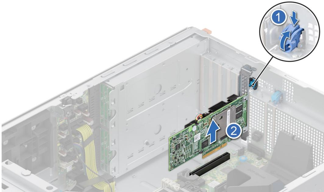
**Ilustración 153. Extracción de una tarjeta de expansión**
