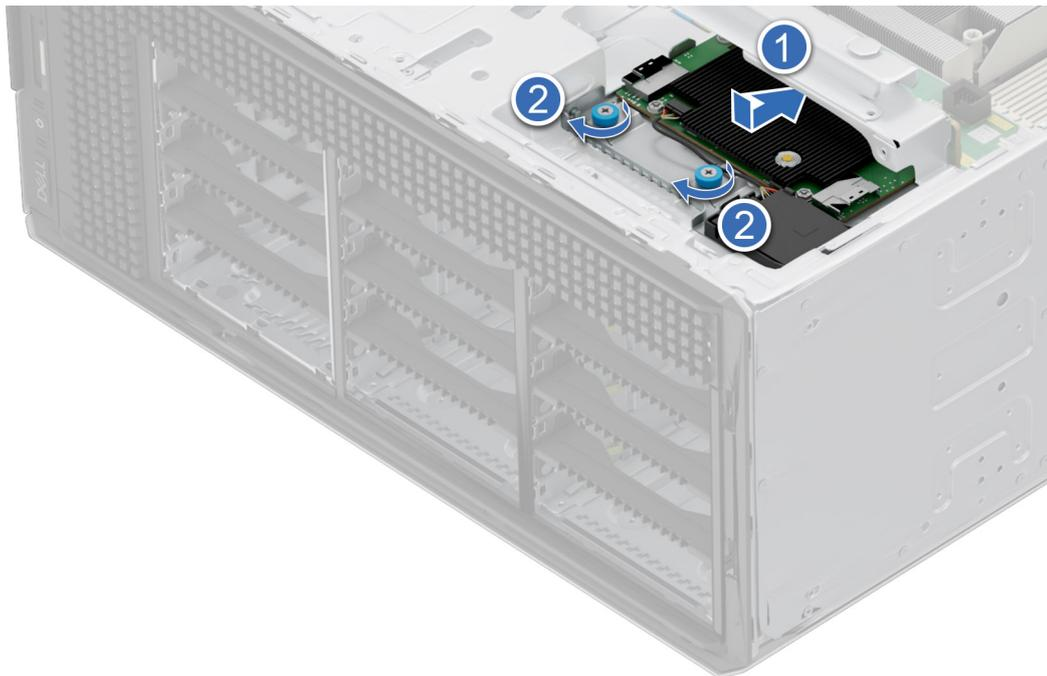
**Ilustración 98. Instalación del módulo de PERC frontal en el backplane de unidades de 3,5 pulgadas**
