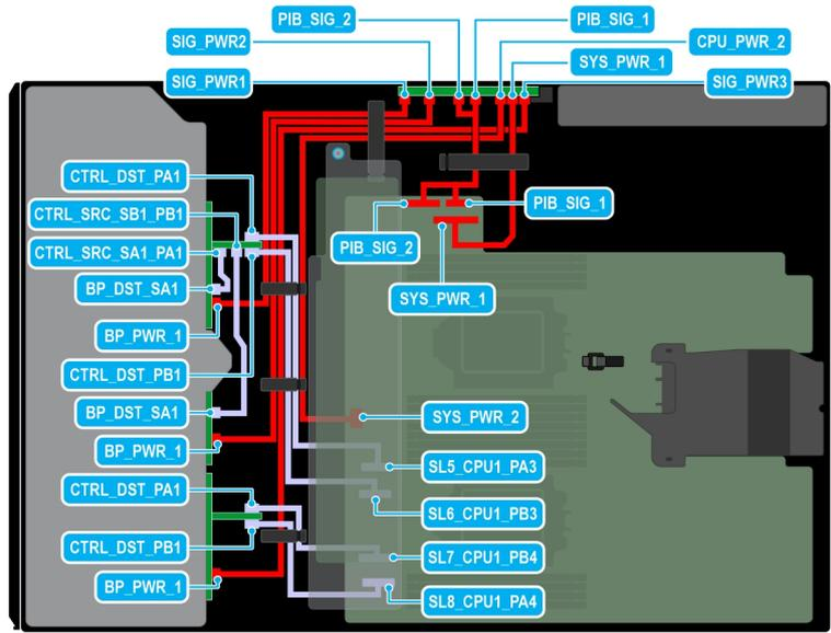
**Ilustración 88. Configuración 50: 24 unidades de 2,5 pulgadas (SAS4/SATA) en fPERC12 en la CPU 2**
