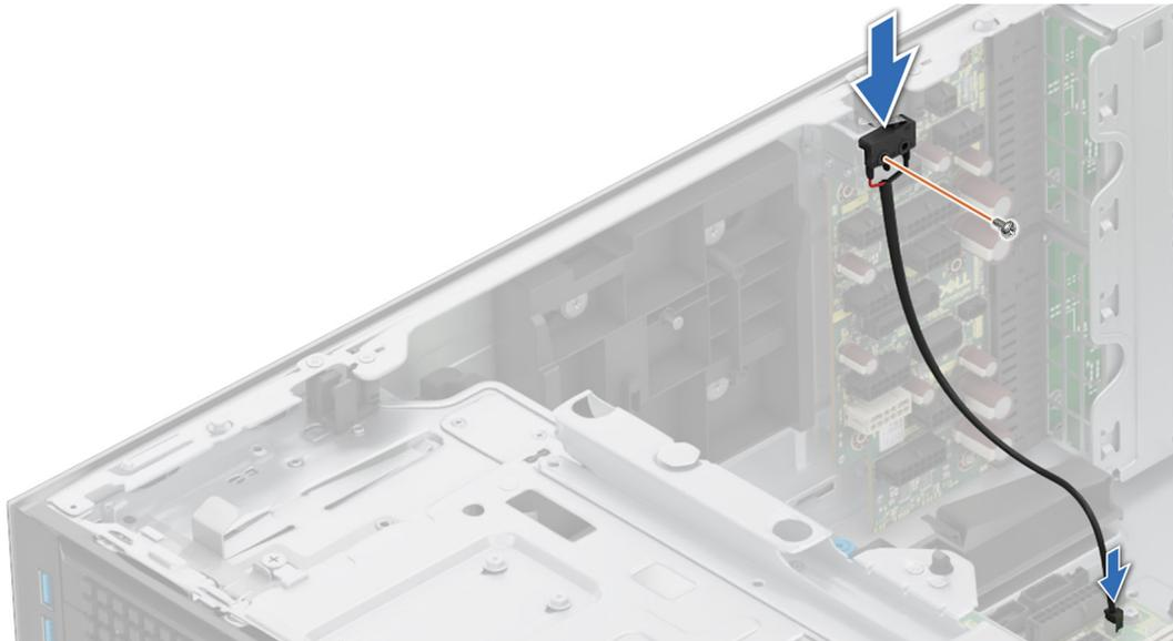
**Ilustración 183. Instalación del módulo del interruptor de intrusiones**
