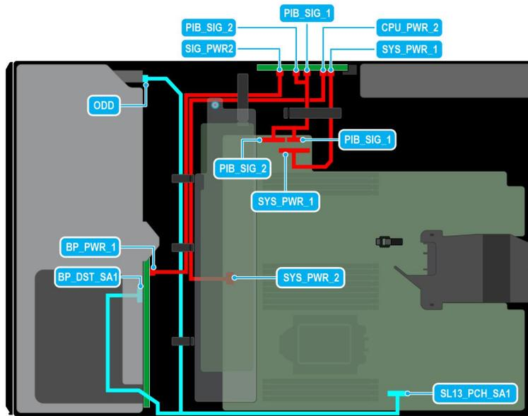
**Ilustración 41. Configuración 3: 8 unidades de 3,5 pulgadas (chipset SATA) en la CPU 1**
