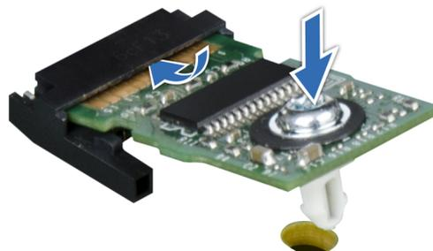
Ilustración 197. Instalación del TPM
