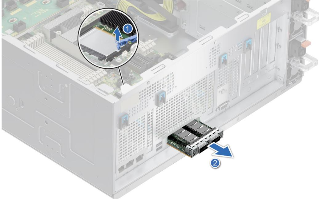
**Ilustración 173. Extracción de la tarjeta OCP**
