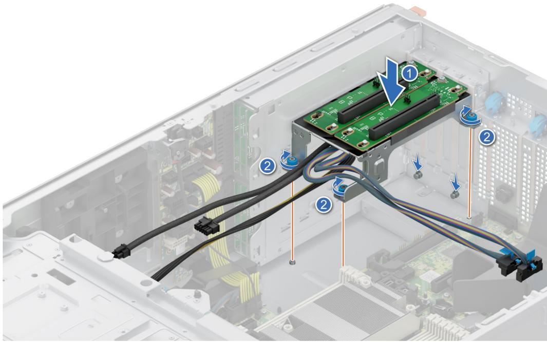
**Ilustración 160. Instalación de la tarjeta elevadora de GPU**
