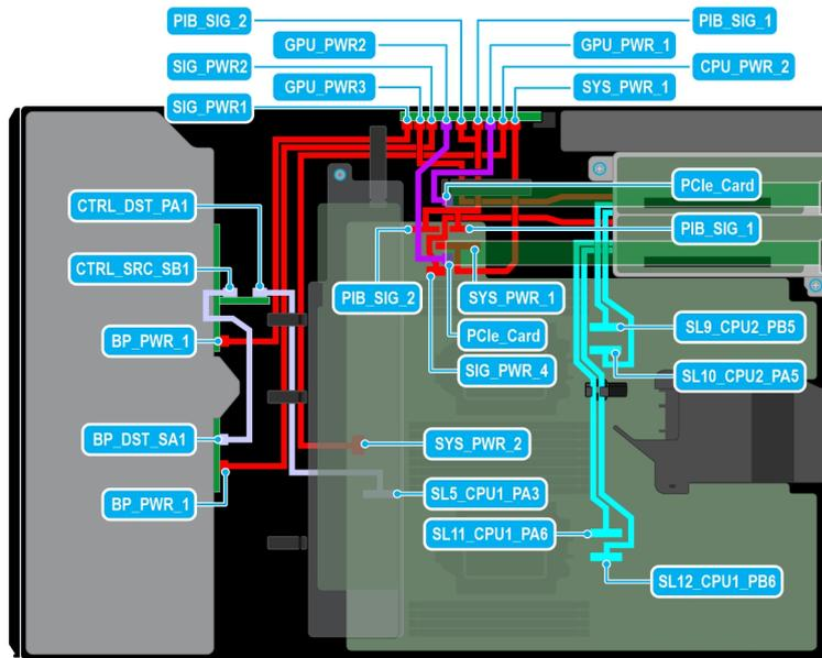
**Ilustración 77. Configuración 39: 16 unidades de 2,5 pulgadas (SAS4/SATA) en fPERC11 + GPUx2 en la CPU 2**
