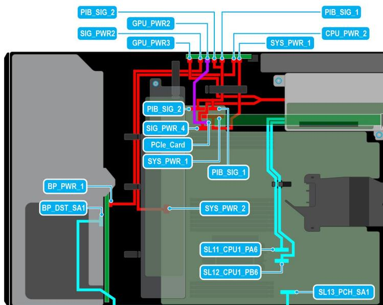
**Ilustración 42. Configuración 4: 8 unidades de 3,5 pulgadas (chipset SATA) + GPUx1 en la CPU 1**
