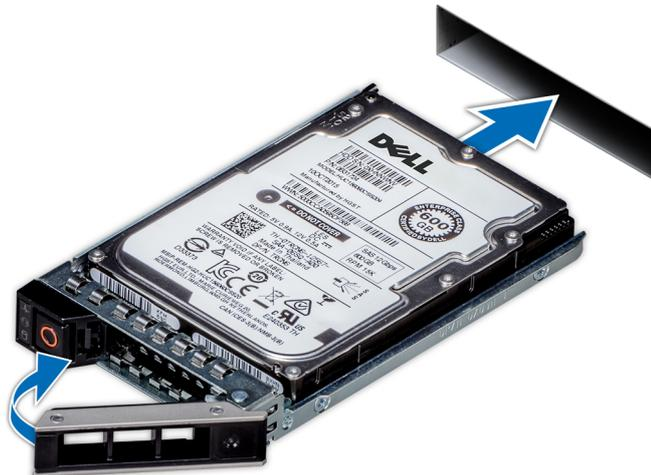
**Ilustración 103. Instalación de un portaunidades**
