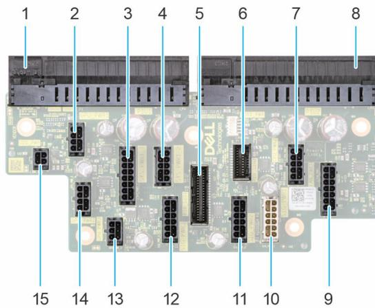
**Ilustración 192. Conectores de la placa intercaladora de alimentación**
