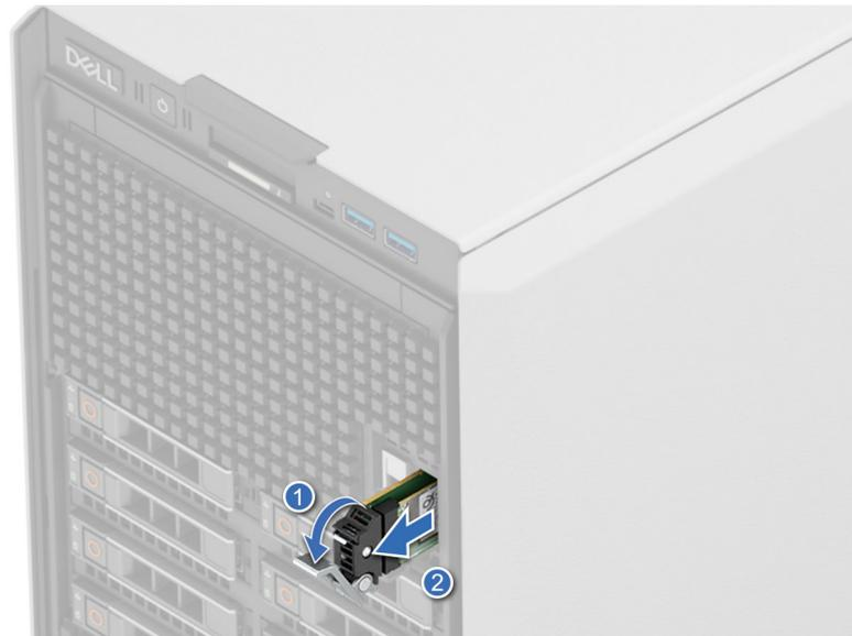
**Ilustración 142. Extracción del portatajadas de tarjeta BOSS-N1**
