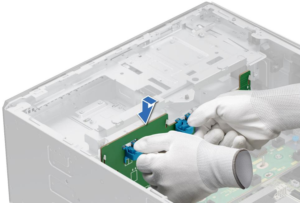
**Ilustración 110. Instalación del backplane para unidades de 3,5 pulgadas**
