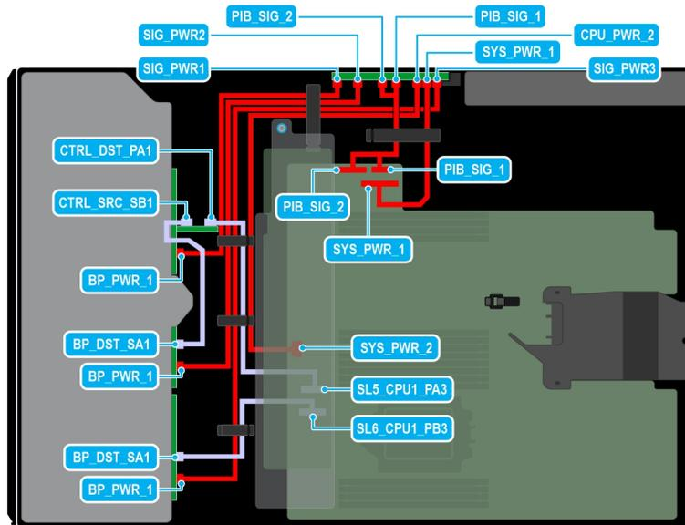
**Ilustración 90. Configuración 52: 24 unidades de 2,5 pulgadas (SAS4/SATA) en fPERC11 en la CPU 1**
