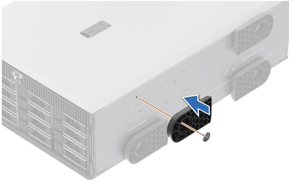
**Ilustración 25. Instalación de los pies del sistema**
