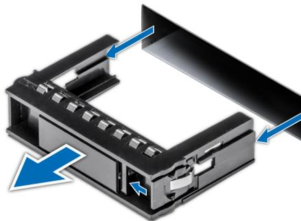
Ilustración 100. Extracción de una unidad de relleno
