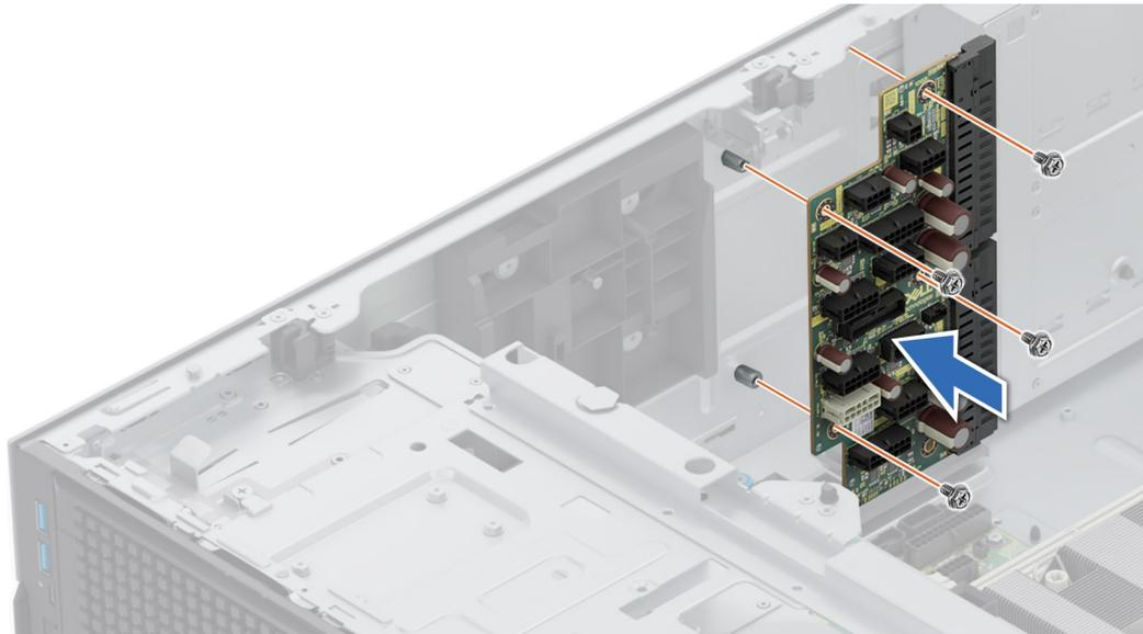
**Ilustración 194. Instalación de la placa intercaladora de alimentación**
