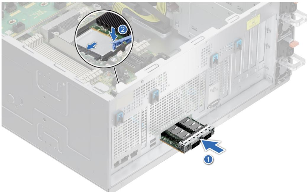
**Ilustración 176. Instalación de la tarjeta OCP**
