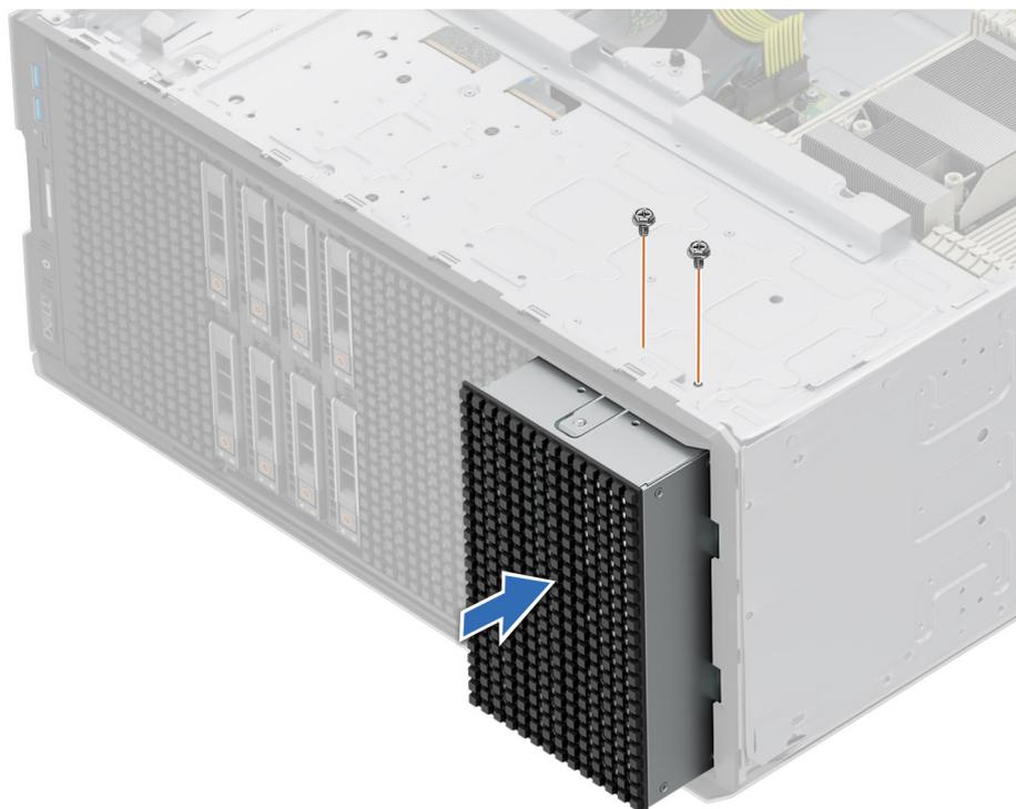
**Ilustración 117. Instalación del panel de relleno de la bahía de unidad**
