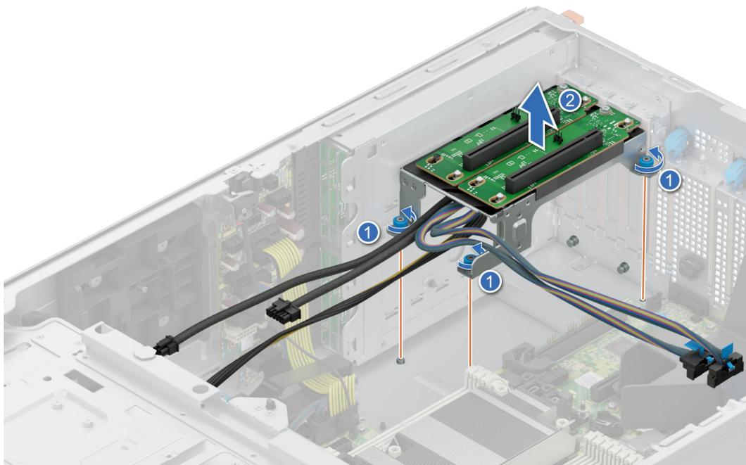
**Ilustración 159. Extracción de la tarjeta elevadora de GPU**
