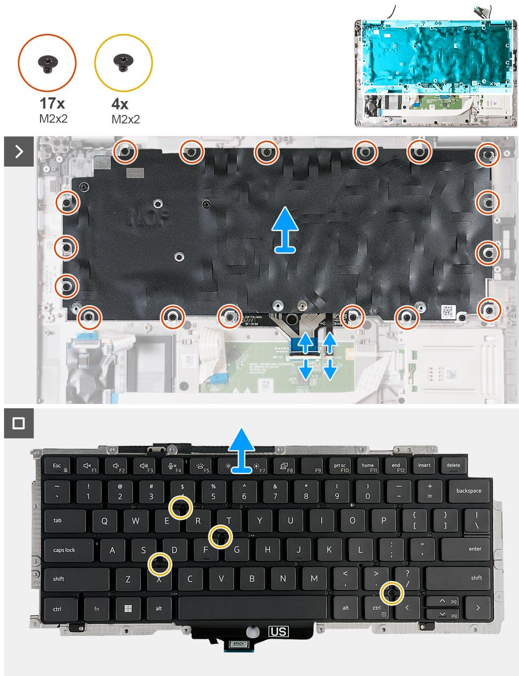
**Ilustración 79. Extracción del teclado**
