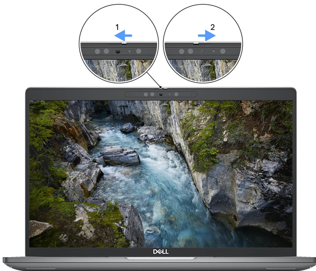
Ilustración 8. Obturador de la cámara
