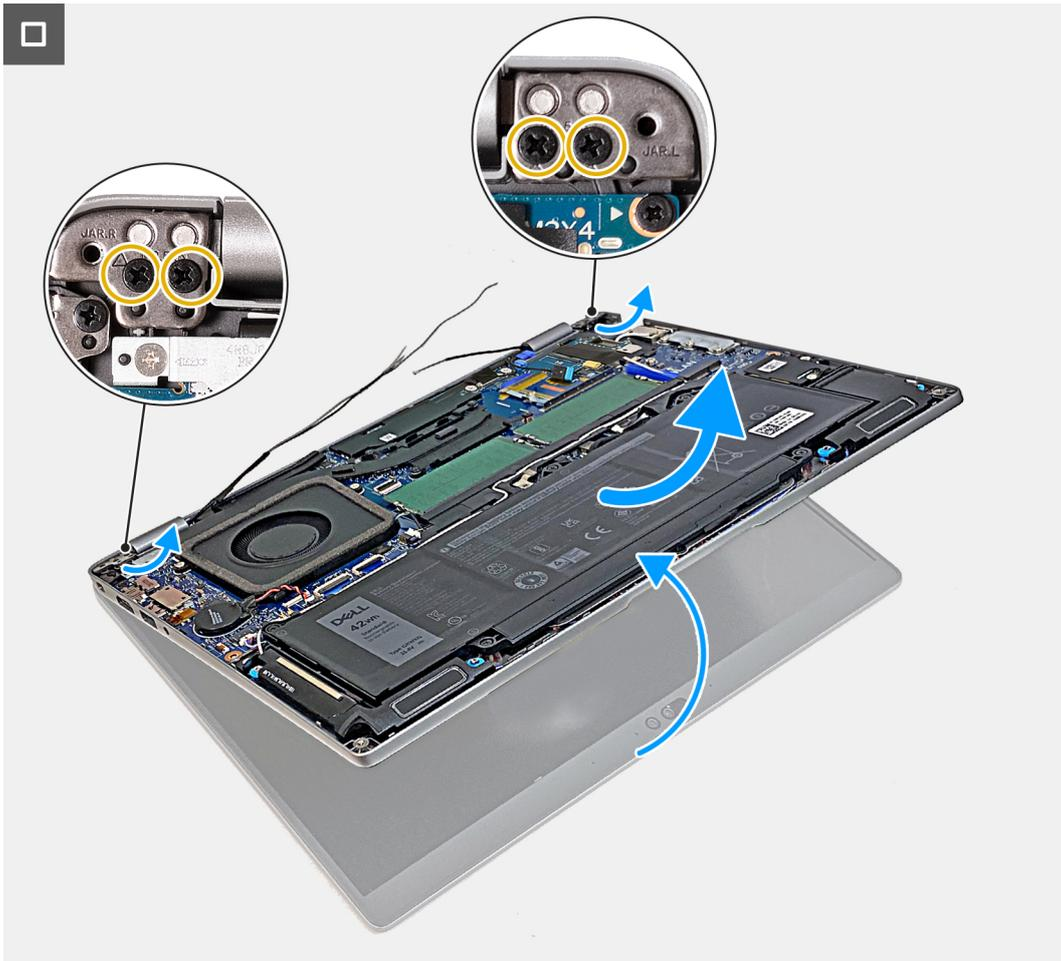
**Ilustración 44. Extracción del ensamblaje de la pantalla: en computadoras que se envían con tarjeta 4G**
