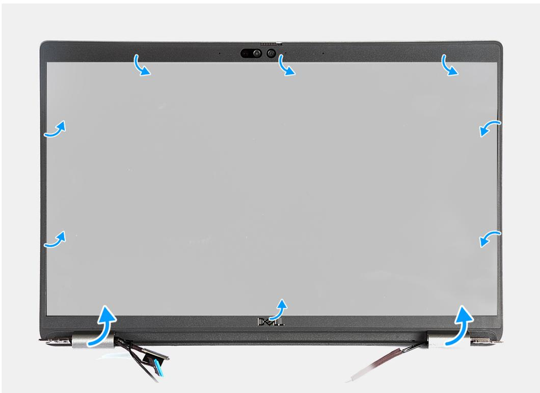
Ilustración 53. Extracción del bisel de la pantalla
