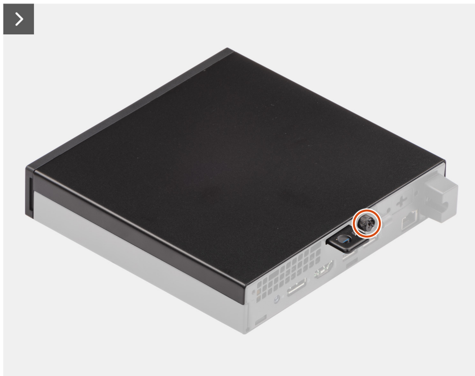
Ilustración 9. Extracción de la cubierta lateral
