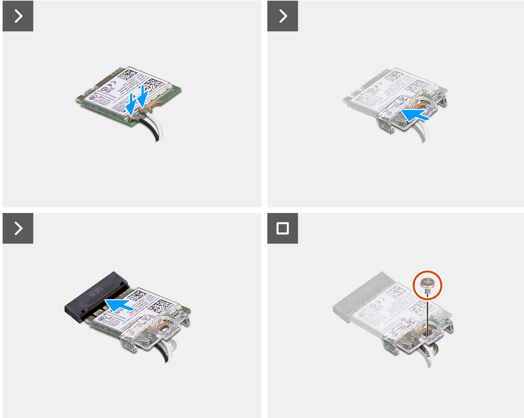
Ilustración 29. Instalación de la tarjeta inalámbrica
