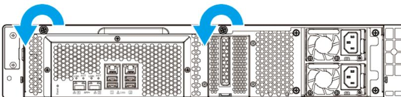
2. Retire la cubierta del NAS con el asa.
