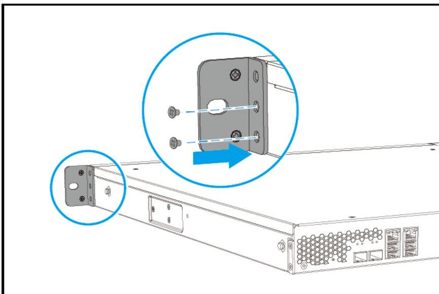
4. Instale una segunda asa en el otro lateral del chasis.
