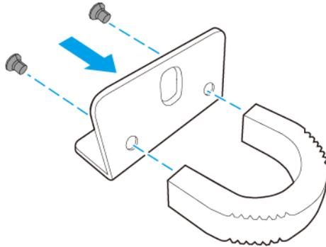
3. Instale el soporte en ángulo en el dispositivo.
