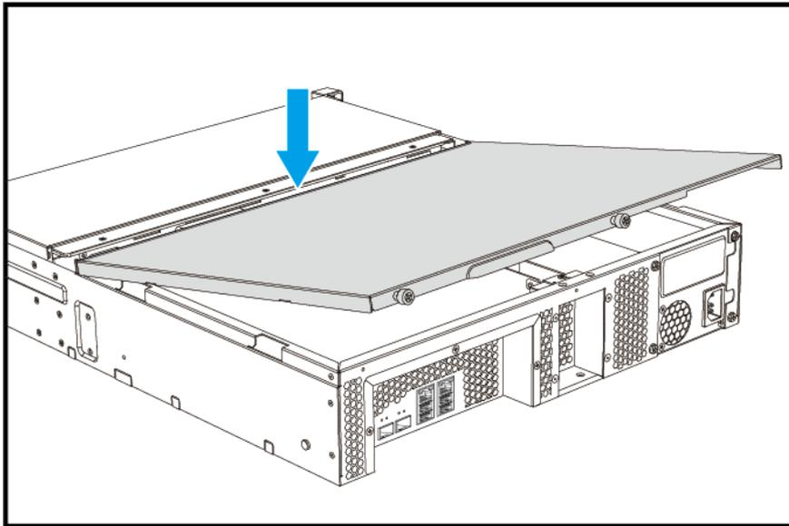
2. Deslice la cubierta hacia delante.
