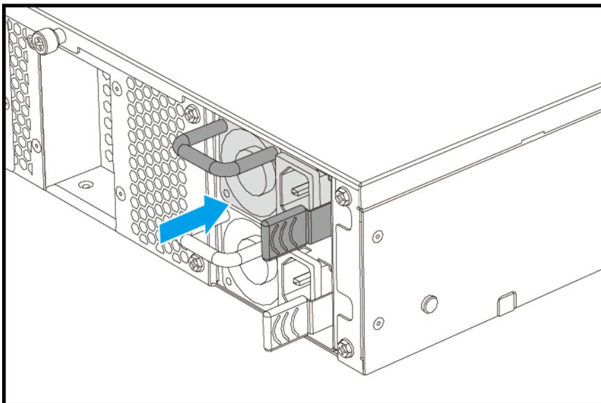
5. Conecte el cable de la alimentación eléctrica a la PSU y la toma de corriente.
