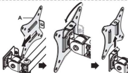
Para colocar los soportes VESA correctamente, inserte la placa VESA y gírela hasta colocarla en posición vertical, tal como se muestra. Cuando haya terminado, retire la placa VESA y continúe con el siguiente paso.
