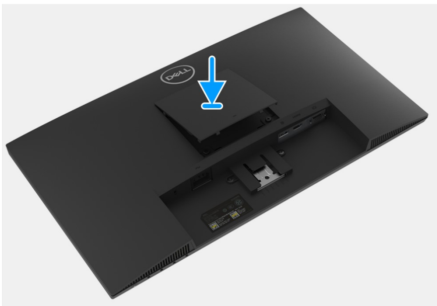
Figura 12. Instalar la cubierta VESA
