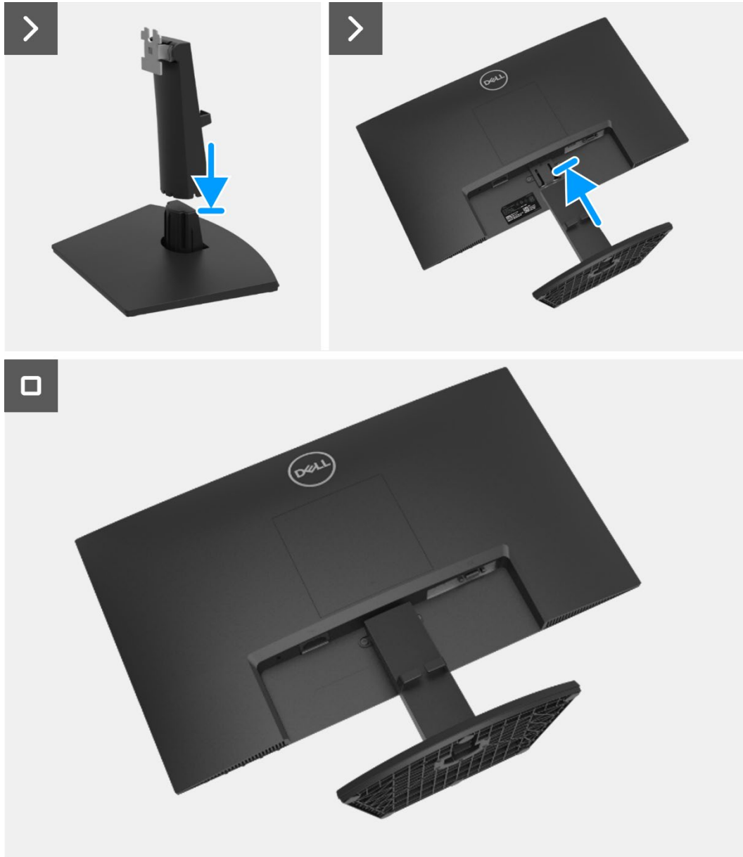
Figura 9. Instalar el pedestal
