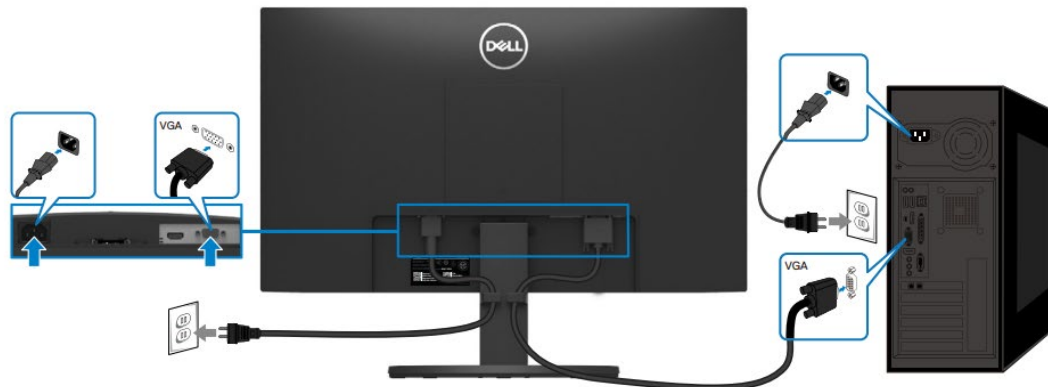
Figura 6. Conectar el cable VGA
