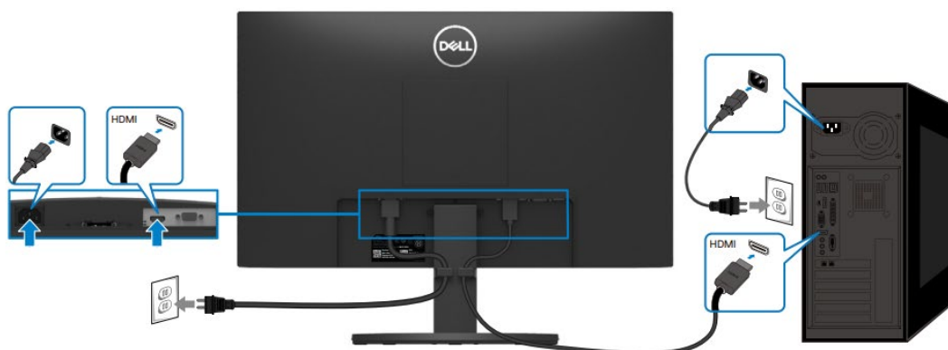
Figura 7. Conectar el cable HDMI
