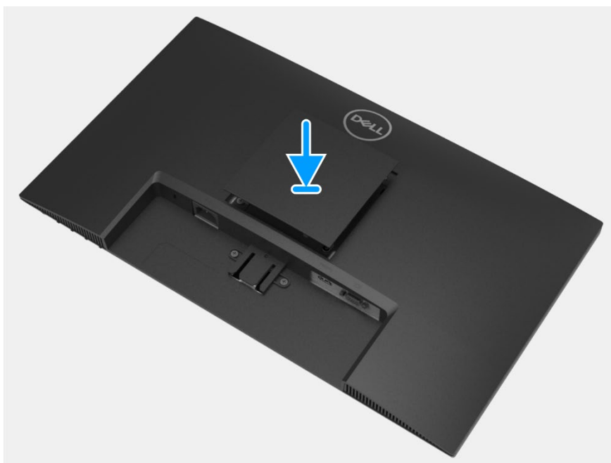
Figura 11. Instalar la cubierta VESA
