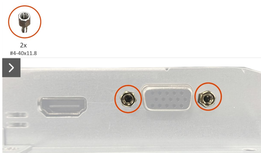
Figura 20. Retire la placa de la interfaz
