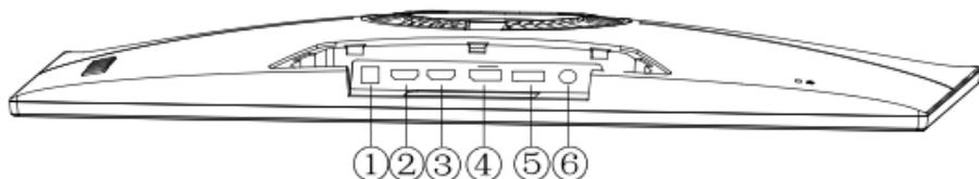
1. Conecte el adaptador de corriente a 1 conector y el otro extremo del adaptador de fuente de alimentación se conecta a la toma de corriente de pared.
