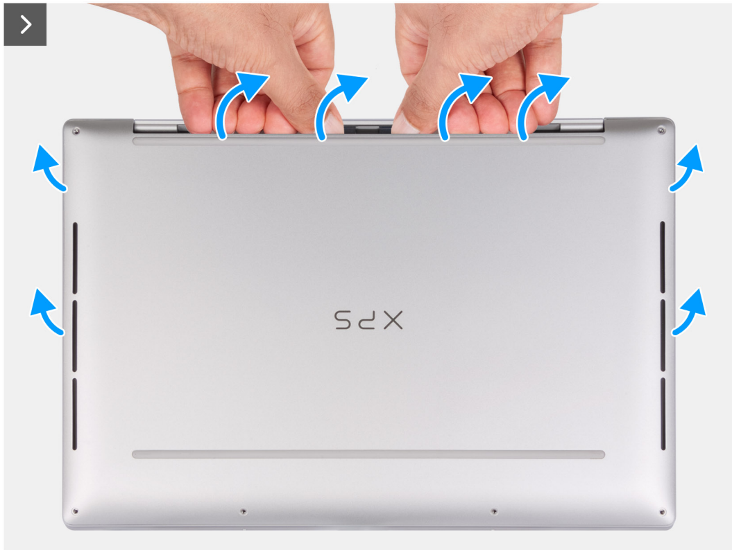
Ilustración 15. Extracción de la cubierta de la base
