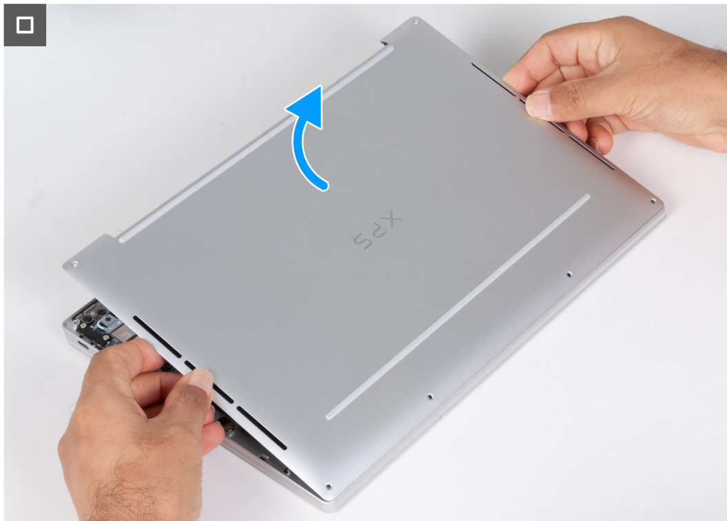
Ilustración 16. Extracción de la cubierta de la base
