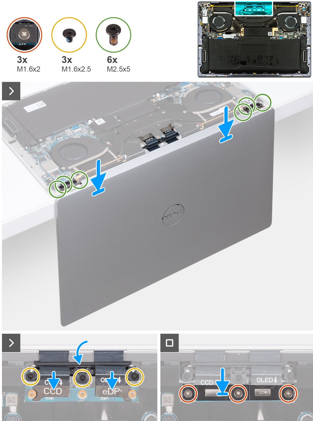
Ilustración 36. Instalación del ensamblaje de la pantalla
