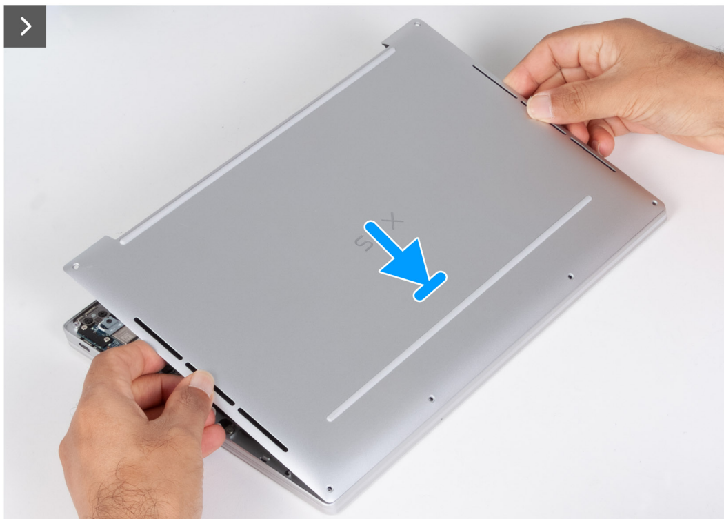
Ilustración 17. Instalación de la cubierta de la base
