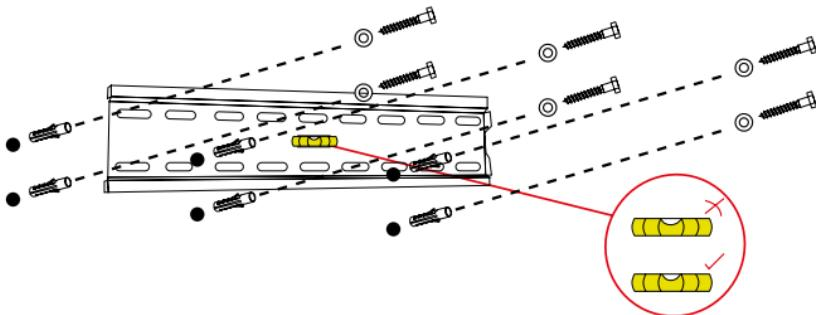
1. Posicionar la base sobre el lugar elegido y utilizar la burbuja niveladora
