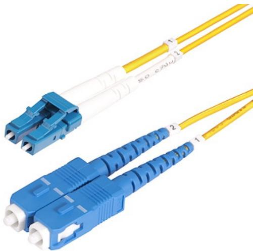
El cable de conexión de fibra óptica dúplex monomodo LC a SC OS2 facilita la conectividad en redes 10G. Es compatible con la multiplexación por división de longitud de onda gruesa (CWDM) en una amplia gama de longitudes de onda de 1260-1625 nm, lo que mejora el aislamiento de los canales para obtener una intensidad de señal óptima en largas distancias.
