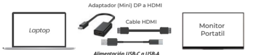
**NOTA:** Utilice el cargador de pared para encender el monitor para evitar que la pantalla se ponga negra o parpadee cuando la fuente de alimentación no es suficiente.
