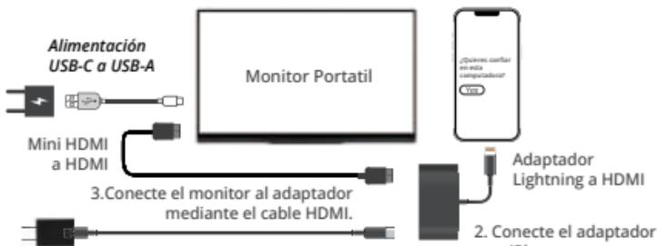
1. Utilice el cargador para proporcionar alimentación al adaptador.
