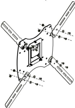
4. Colocar la pantalla en una superficie suave y plana, localizar los puntos para montaje y determinar que tornillos usar dependiendo de la profundidad del orificio (véase contenido)
