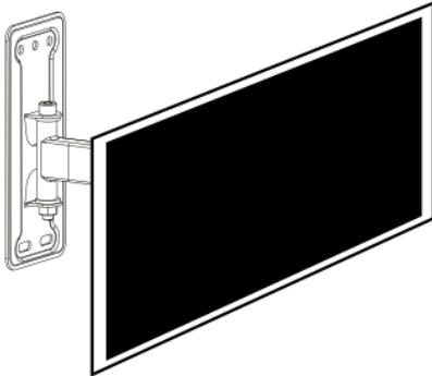
5. Con ayuda de otra persona fijar la pantalla a la base del plato, posteriormente sujetar el plato al brazo utilizando las tuercas M6 utilizando la llave inglesa (véase contenido)
