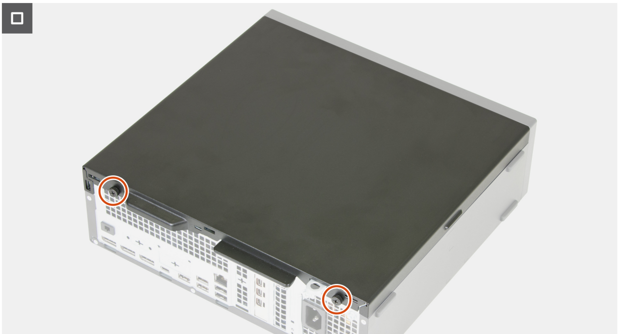
Ilustración 9. Instalación de la cubierta lateral
