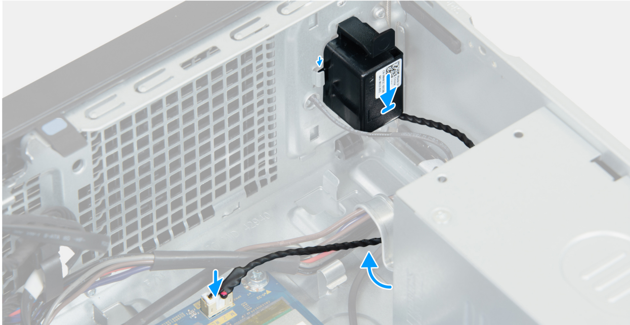
Ilustración 19. Instalación del altavoz interno
