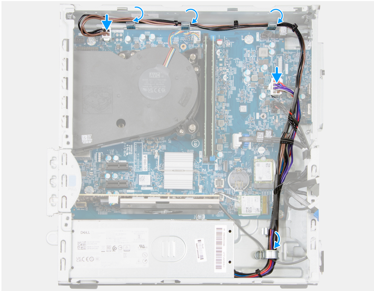
Ilustración 51. Instalación de la fuente de alimentación
