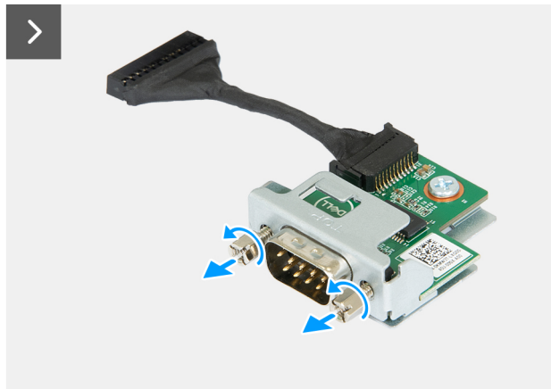
Ilustración 58. Instalación del módulo de puerto serial
