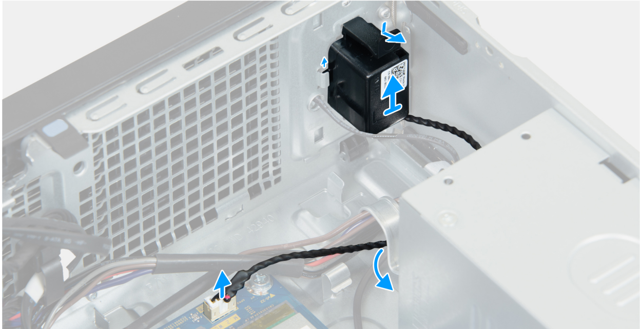
Ilustración 18. Extracción del altavoz interno
