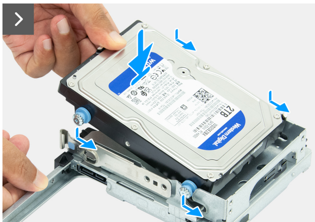
Ilustración 41. Instalación del disco duro
