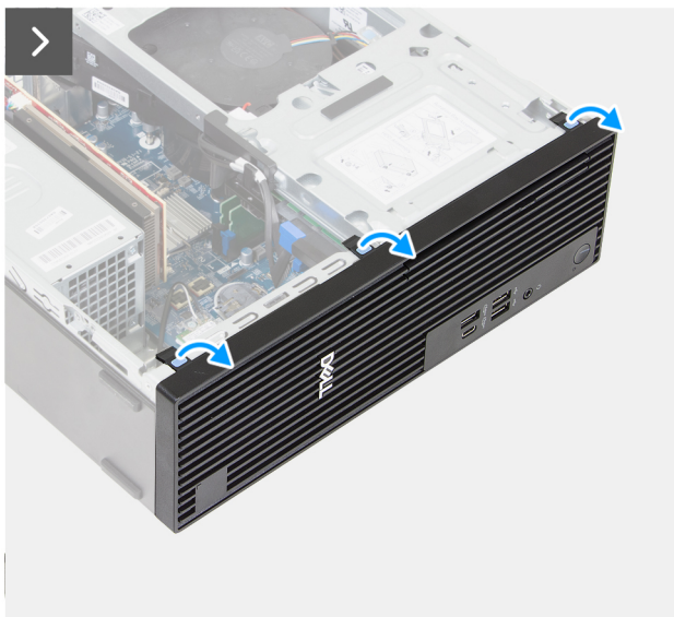
Ilustración 16. Extracción de la cubierta frontal
