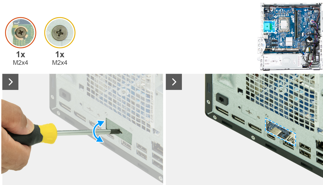
Ilustración 55. Instalación del módulo de puerto opcional
