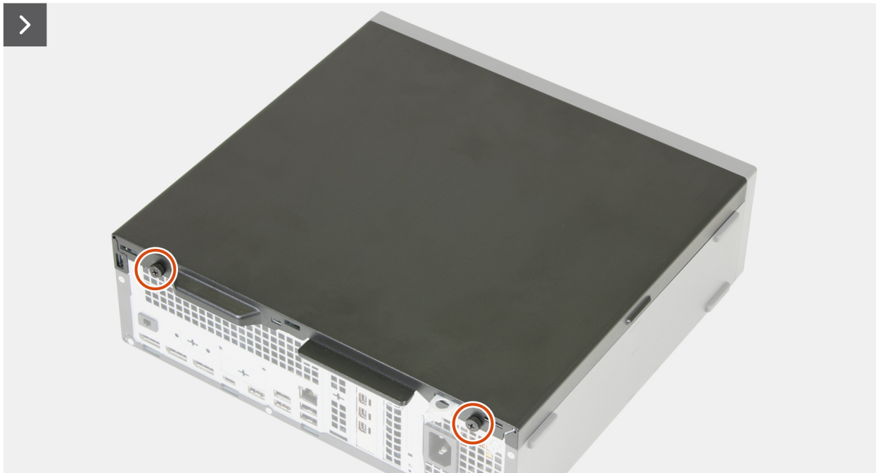
Ilustración 6. Extracción de la cubierta lateral
