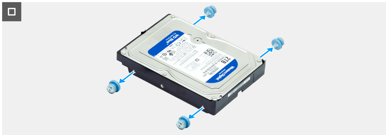
Ilustración 40. Extracción del disco duro
