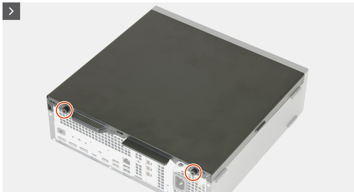
Ilustración 6. Extracción de la cubierta lateral
