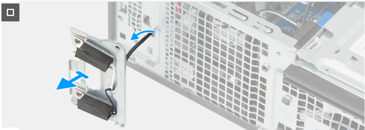
Ilustración 46. Extracción de los módulos de la antena
