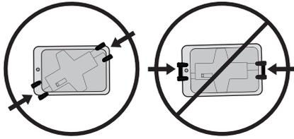
¡PRECAUCIÓN! No monte la tableta con brazos en los laterales o extremos de la tableta. Una solamente los brazos a las esquinas de la tableta. En caso de no respetar estas instrucciones, la instalación podría ser poco segura y puede que la tableta se caiga del soporte y ocasione posibles daños en el equipo.
