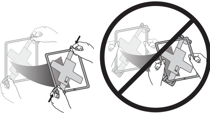
¡Importante! Sostenga las asas cuando mueva la tableta montada. Si no sostiene las asas, puede provocar que la tableta se salga del soporte y se caiga, lo que puede ocasionar daños en el equipo.
