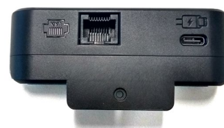
Adaptador para tarjeta de red ethernet (RJ45) y con entrada para cable de alimentación con conexión USB-C.
