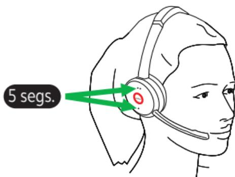
Para desactivar la función de busylight por completo, mantenga presionados los botones **Volumen+** y **Volumen -** al mismo tiempo durante 5 segundos. La desactivación de la función Busylight evitará el uso de las Busylights.
